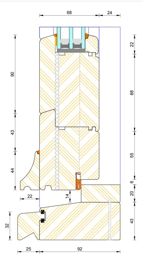
CILL EXTENSION - available options: 25mm (117mm o/a) / 47mm (139mm o/a) / 62mm (154mm o/a) / 87mm (179mm o/a) / 114mm (206mm o/a) / 125mm (217mm o/a) / 140mm (232mm o/a)
