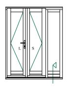
CILL EXTENSION - available options: 25mm (93mm o/a) / 47mm (115mm o/a) / 62mm (129mm o/a) / 87mm (155mm o/a) / 114mm (182mm o/a) / 125mm (193mm o/a) / 140mm (208mm o/a)
