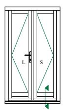
CILL EXTENSION - available options: 25mm (111mm o/a) / 47mm (133mm o/a) / 62mm (148mm o/a) / 87mm (173mm o/a) / 114mm (200mm o/a) / 125mm (211mm o/a) / 140mm (223mm o/a)
