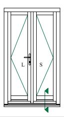
CILL EXTENSION - available options: 25mm (111mm o/a) / 47mm (133mm o/a) / 62mm (148mm o/a) / 87mm (173mm o/a) / 114mm (200mm o/a) / 125mm (211mm o/a) / 140mm (223mm o/a)
