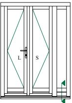
CILL EXTENSION - available options: 25mm (111mm o/a) / 47mm (133mm o/a) / 62mm (148mm o/a) / 87mm (173mm o/a) / 114mm (200mm o/a) / 125mm (211mm o/a) / 140mm (223mm o/a)
