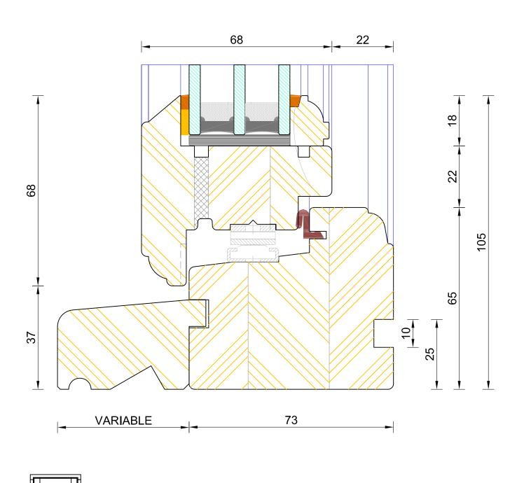
CILL EXTENSION - available options: No Sub-Cill - 25mm (98mm o/a) / 47mm (120mm o/a) / 62mm (135mm o/a) / 87mm (160mm o/a) / 100mm (173mm o/a) / 114mm (187mm o/a) / 125mm (198mm) / 140mm (213mm o/a)
