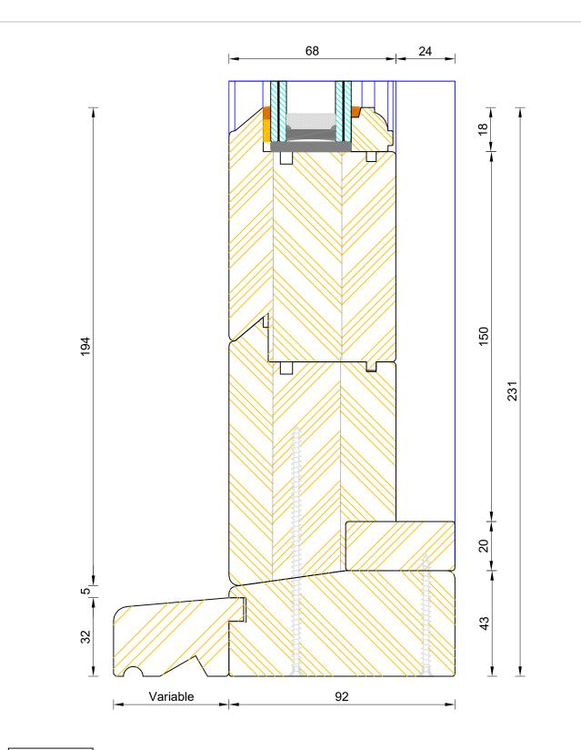
CILL EXTENSION - available options: 25mm (117mm o/a) / 47mm (139mm o/a) / 62mm (154mm o/a) / 87mm (179mm o/a) / 114mm (206mm o/a) / 125mm (217mm o/a) / 140mm (232mm o/a)
