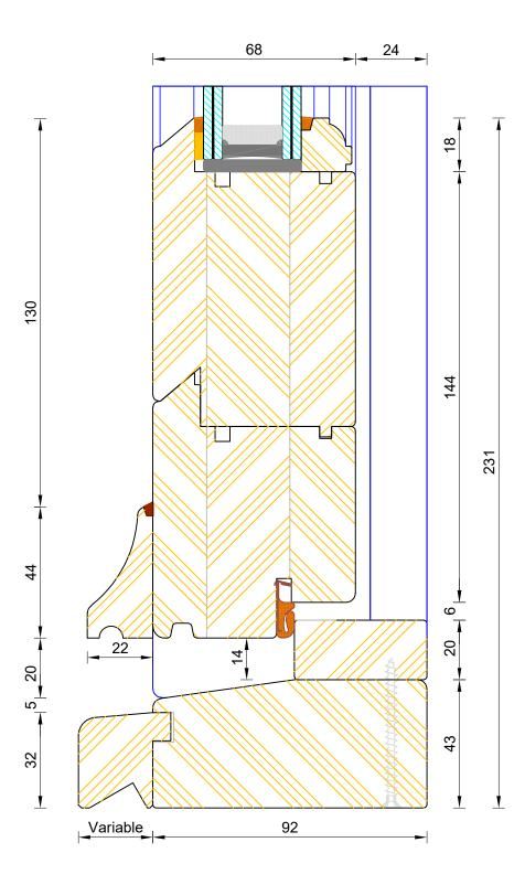
CILL EXTENSION - available options: 25mm (117mm o/a) / 47mm (139mm o/a) / 62mm (154mm o/a) / 87mm (179mm o/a) / 114mm (206mm o/a) / 125mm (217mm o/a) / 140mm (232mm o/a)
