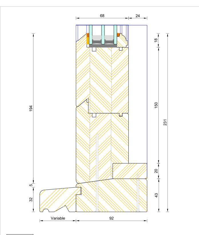
CILL EXTENSION - available options: 25mm (117mm o/a) / 47mm (139mm o/a) / 62mm (154mm o/a) / 87mm (179mm o/a) / 114mm (206mm o/a) / 125mm (217mm o/a) / 140mm (232mm o/a)
